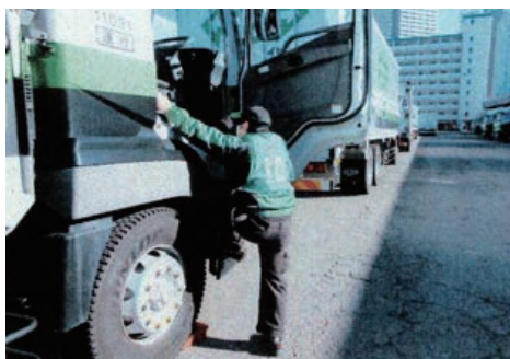
墜落・転落防止:三点支持の徹底
