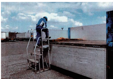
墜落・転落防止:昇降台の導入
