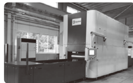
巨大な航空機の機体部品成形を行う液圧成形プレス
