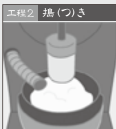
工程2 搗(つき) 蒸し上がったもち米を丸粒のまま搗(つき)きます。
