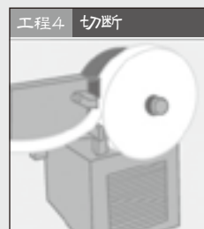
工程4 七刀断 固まった餅を裁断してあられ・おかきの生地にします。
